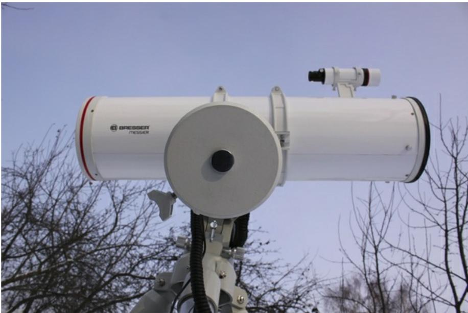
Белое лакированное покрытие трубы хорошо защищает от солнечных лучей и в то же время выделяет телескоп в сумерках и ночью на фоне окружающего пейзажа.
