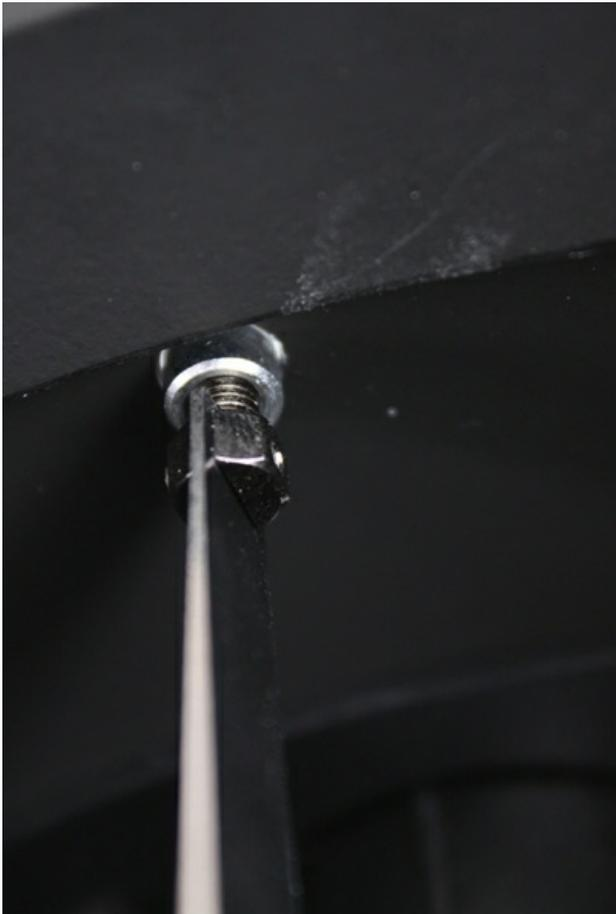
Искатель юстируется при помощи двух винтов, пружинный фиксатор автоматически устраняет люфт юстировки. Перед началом наблюдений наведите телескоп на удаленный объект и выставьте по нему искатель. Для удобства в темноте не забывайте включать подсветку перекрестия.
