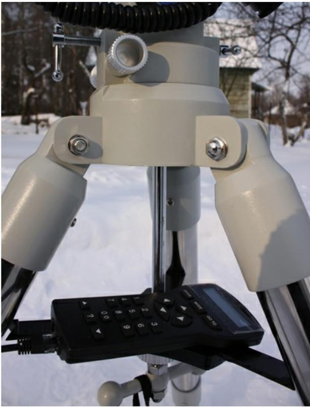
В конструкции распорок треноги есть ручка, на которую можно повесить блок питания для монтировки. При сборе треноги обратите внимание на втулку, которая устанавливается на верхнюю часть оси.
