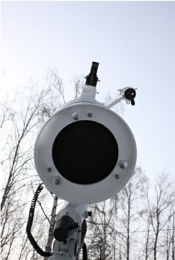
Тесты, о которых будет сказано в конце обзора, показали, что заводская юстировка выполнена хорошо и производить дополнительную настройку системы нужно только в случае острой необходимости. На фотографии - винты для юстировки главного зеркала телескопа.
