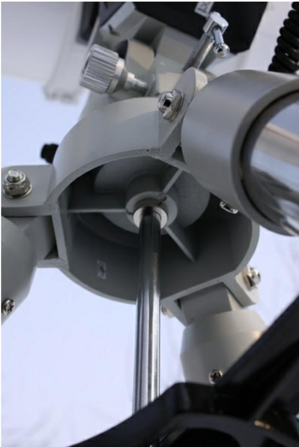
Тренога у BRESSER NT-203 низкая. Она имеет телескопическую конструкцию и ее высота может настраиваться с учетом роста наблюдателя. Дополнительным элементом, придающим жесткость треноге, является практичная полочка для размещения на ней окуляров и других аксессуаров с посадочным диаметром 1,25" или 2". Рейка крепления к монтировке укреплена двумя стальными ребрами жесткости.
