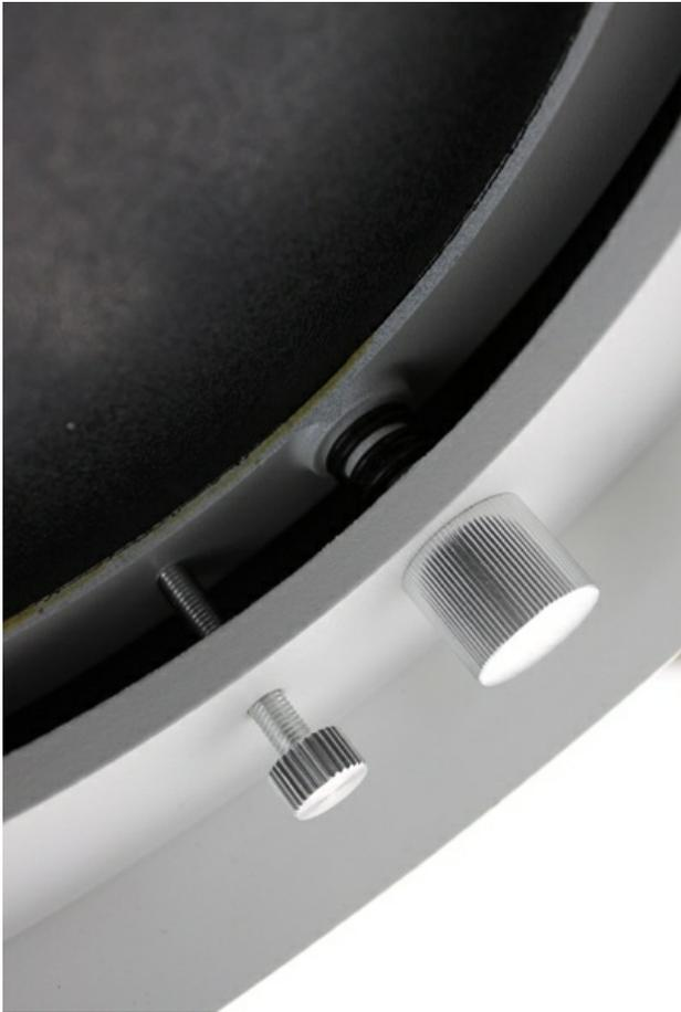
Аздесь показан мощный винт хомута (кольца) крепления трубы. Закручивать винты нужно не до конца, а с таким усилием, чтобы труба не проворачивалась в хомутах.
